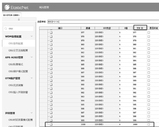
(a) 单OTU4接口可配置最大OSU连接数
