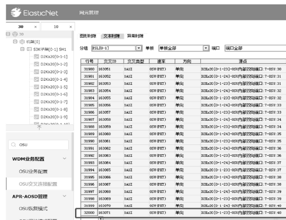
(b) 单节点可配置最大OSU连接数
